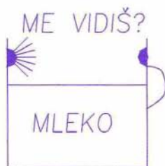
Slika 2. Ko se mleko dviga, električno oko ne vidi več lučke.
