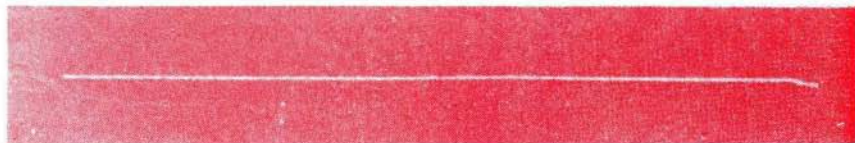
Slika 1. V prenasičeno vlažnem zraku meglične celice zapusti hitri naelektreni delec sled kapljic. Eden izmed prvih posnetkov C.T.R. Wilsona je vzeta iz njegovega govora ob podelitvi Nobelove nagrade leta 1927.
